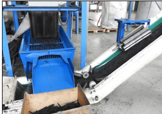
Nastanak sirovine gumenih niti na liniji 2
