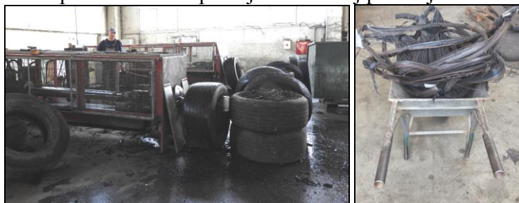
Proces pripreme prije uporabe (stroj čupač) (lijevo) te izdvojeni otpad KBO 19 12 02 (vulci) (desno)
