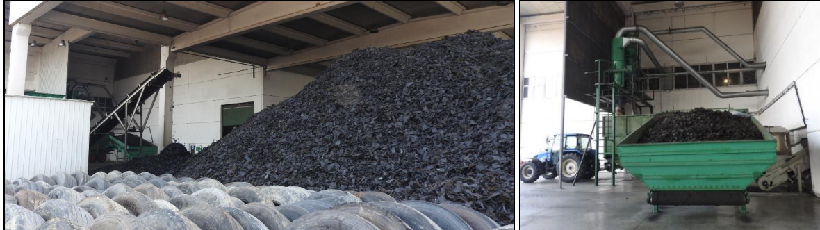
Izrezana guma koja izlazi iz „šredera“ (lijevo) te transport izrezane gume do sljedećeg stroja za usitnjavanje gume (desno)
