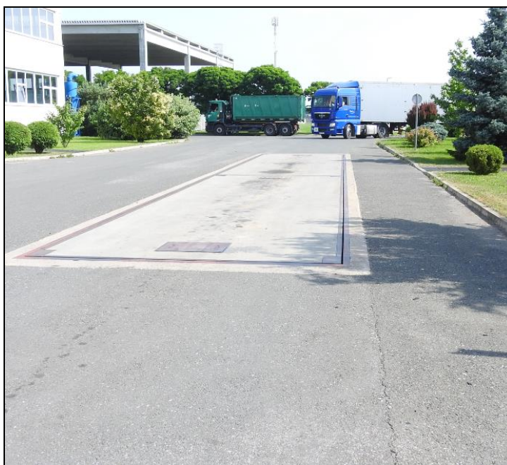
Kolna vaga unutar lokacije gospodarenja otpadom na kojoj se odvija prihvat otpada
